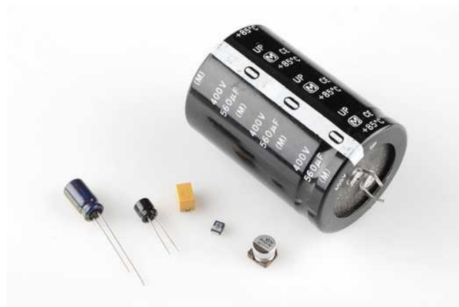
Asortiman elektrolitskih kondenzatora s otvorom i površinskom ugradnjom. Imajte na umu da svaki ima neku metodu za označavanje katode (negativni vod).
